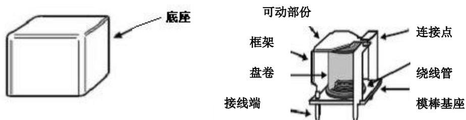
\* 对用于塑料阻燃剂的特殊金属(合金)、连接点的电子特性和润滑作用应特别注意。
