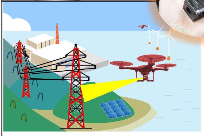
社会インフラ検査 (送電鉄塔の塗膜下塩害腐食検査)
